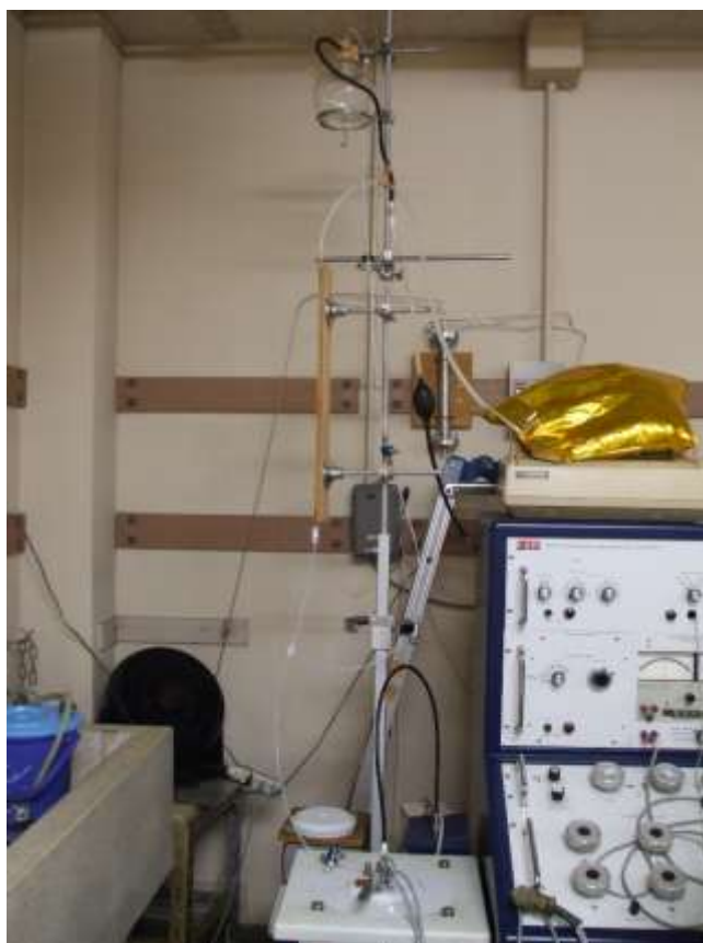
写真 2. 1P-Probing 法用の微分混合熱測定装置
