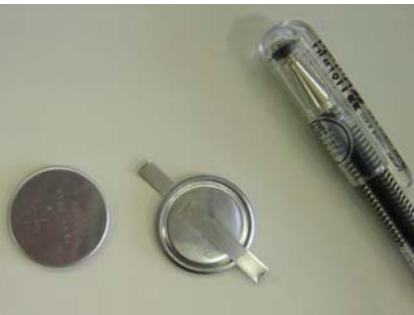
TOT類を使って開発した、レアメタルを必要としない「分子スピン電池」。従来のリチウムイオン電池と比べると最大2倍の容量の電気エネルギーの充放電ができる。
