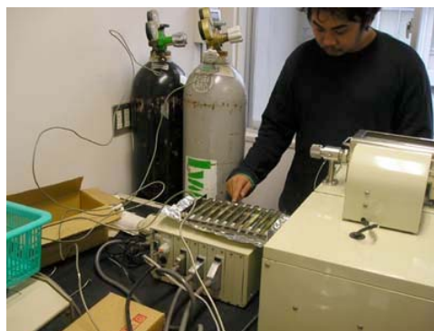
図 2. アラミド繊維に含まれている炭素・窒素の同時定量
